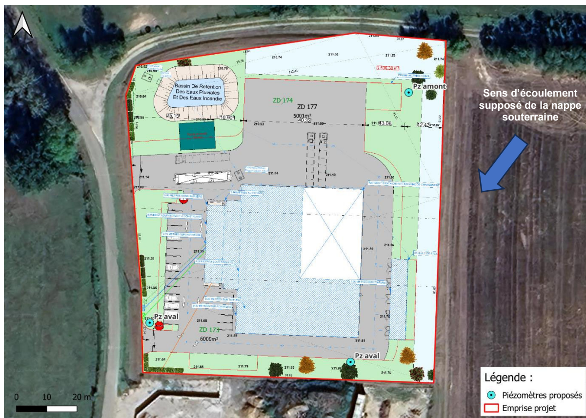
FIGURE 22 : PLAN PREVISIONNEL DU RESEAU PIEZOMETRIQUE AU SEIN DE L'EMPRISE DU FUTUR SITE D'ADLCA.
