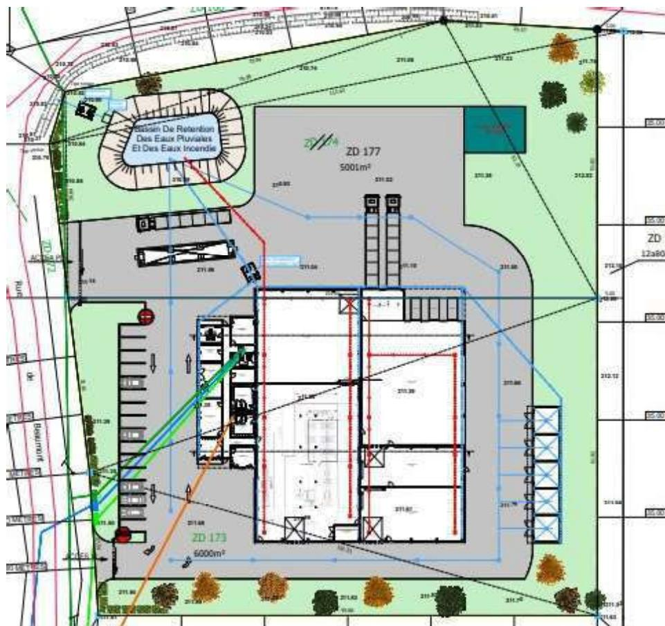
A noter que le projet n'intercepte pas d'eaux pluviales s'écoulant gravitairement du bassin-versant situé en amont et que le rejet après rétention s'effectuera dans un fossé privatif.
