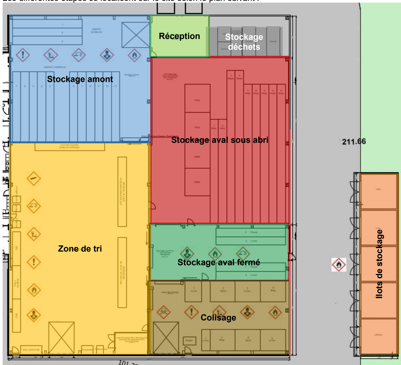
FIGURE 6 : PLAN DE DETAIL DU BATIMENT PRODUCTION/STOCKAGE (SOURCE : ADLCA, ECHELLE : NON CONTRACTUELLE)
