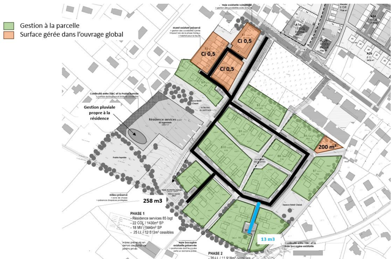
Figure 8 : Schéma de principe de la gestion pluviale prévue
