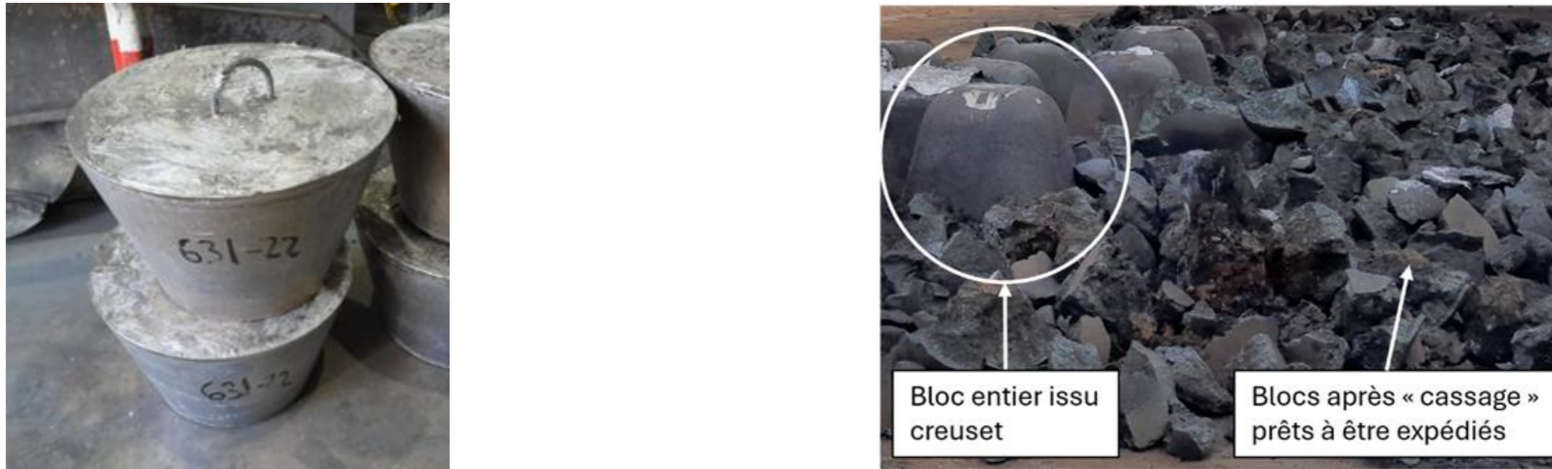
Figure 36 : Deux types de scories : scories d'affinerie à gauche et scories de fusion à droite
