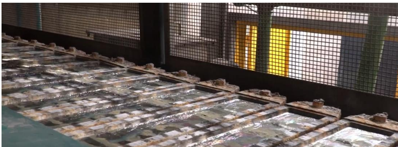
Figure 20 : Lingotière sur la ligne automatisée (source international lead association)
