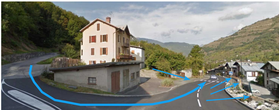
Figure III.36: hameau de Vignotan potentiellement exposé aux ruissellements ; l'eau provenant de plusieurs combes peut se propager via les routes et ruisseler à travers le hameau.
