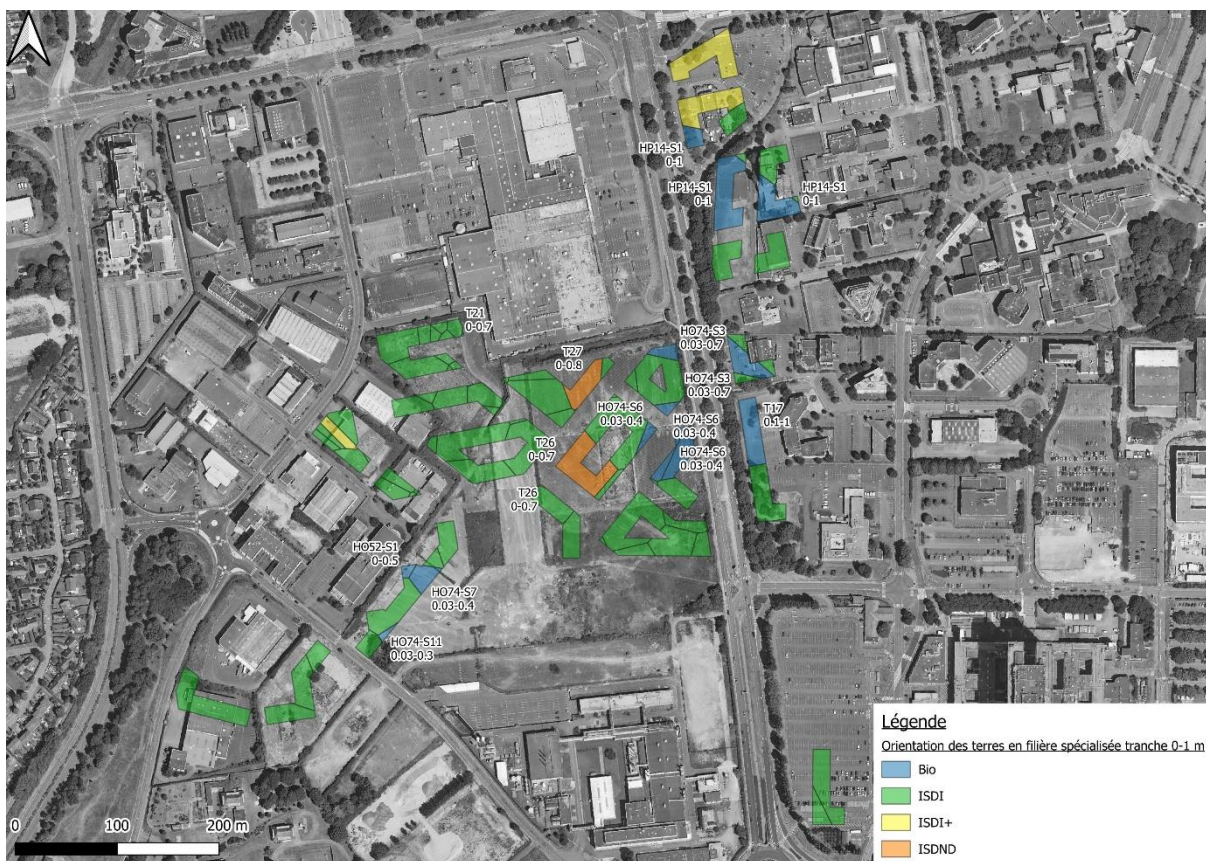
Figure 31 Orientation des terres excavées dans le cadre de la création des sous-sols sur deux niveaux à différentes hauteurs entre 0 et 1 m.
