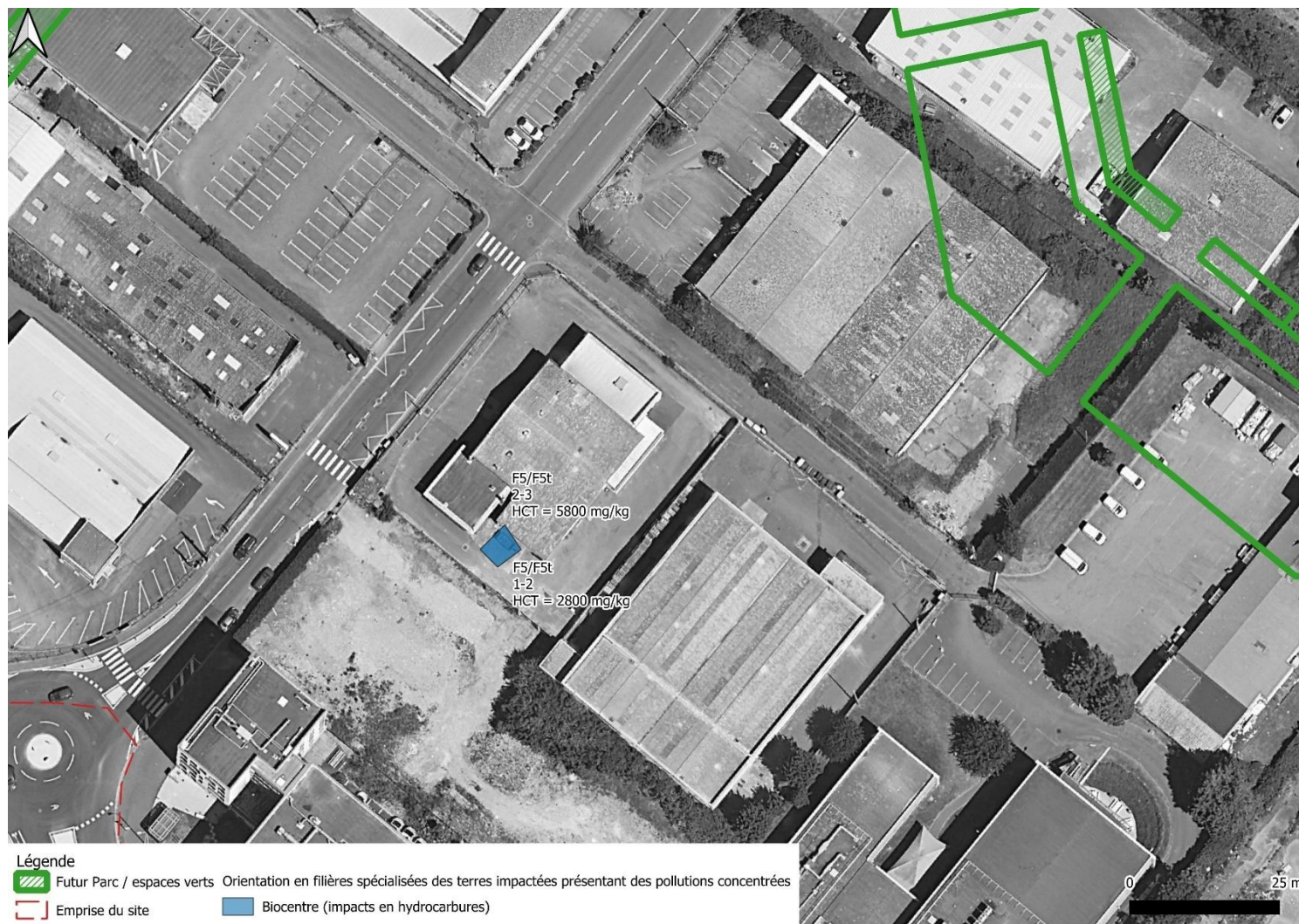
Figure 14 Cartographie des impacts en hydrocarbures dans les sols entre 1 et 3 m de profondeur sur la parcelle HO17 (cuve fuyarde).
