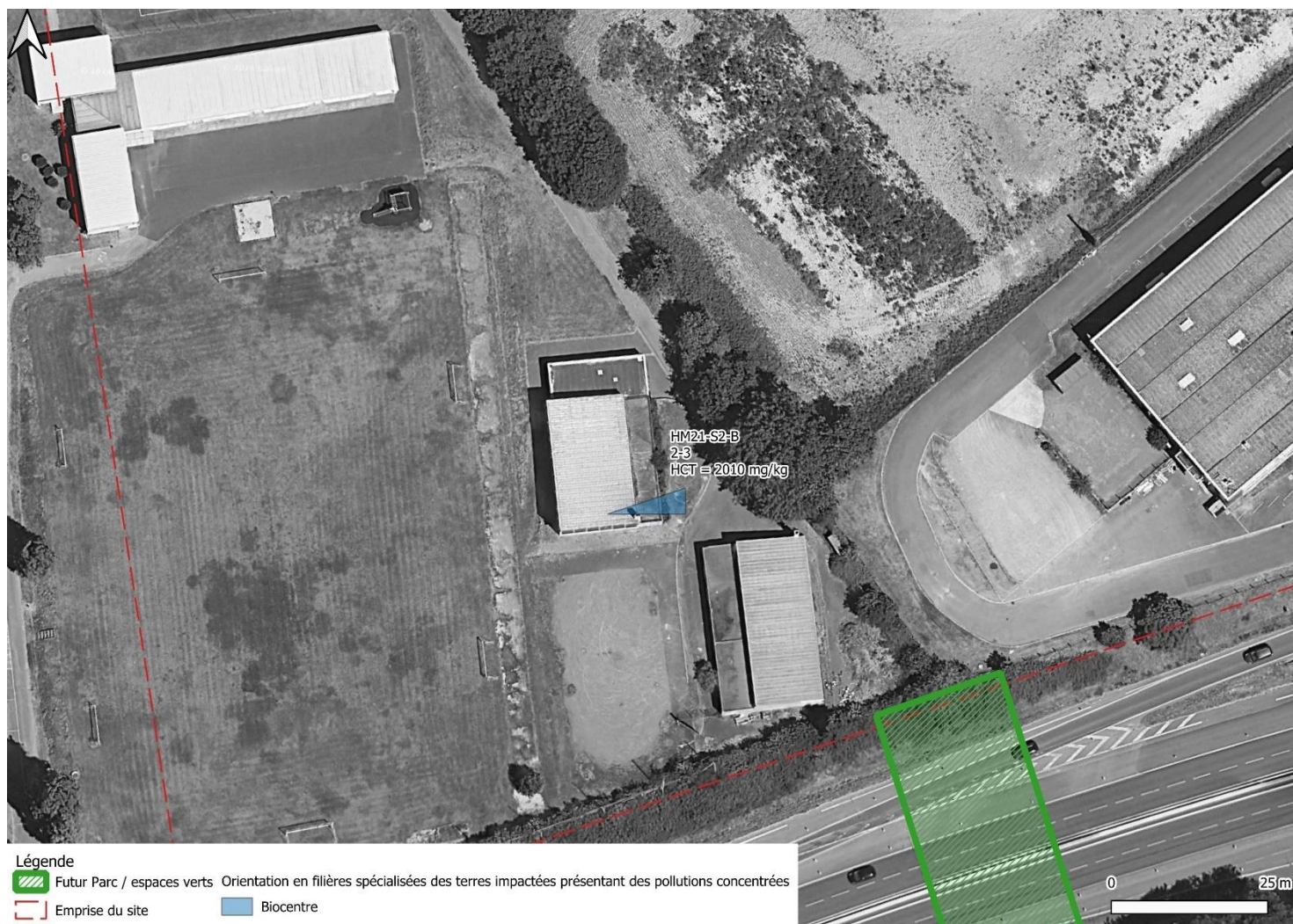
Figure 15 Cartographie des impacts en hydrocarbures dans les sols entre 2 et 3 m de profondeur sur la parcelle HM21 (cuve fuyarde).
