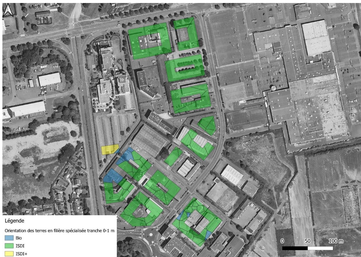
Figure 30 Orientation des terres excavées dans le cadre de la création des sous-sols sur un niveau à différentes hauteurs entre 0 et 1 m.
