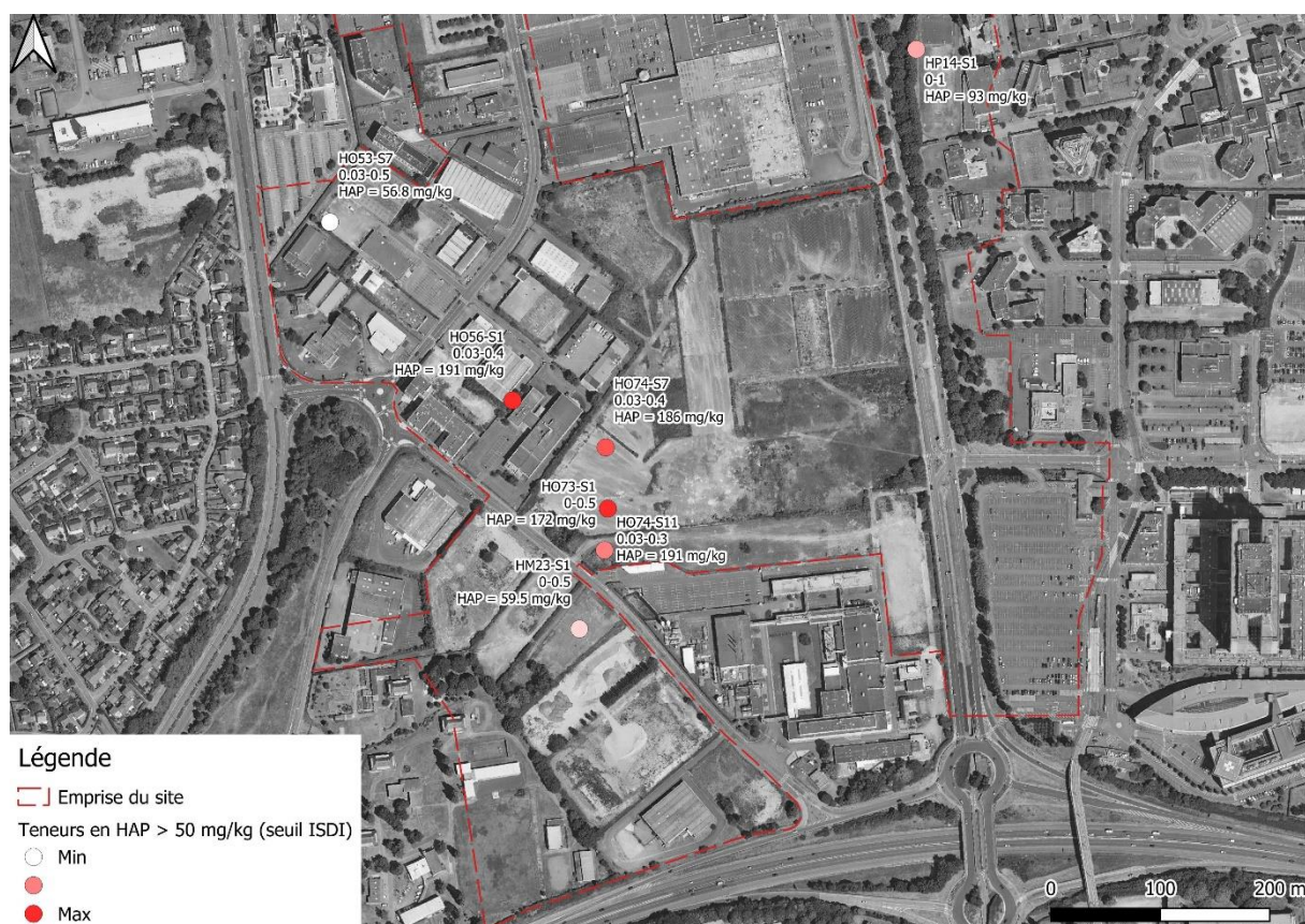
Figure 11 Cartographie des teneurs notables en HAP au droit de la Zac
