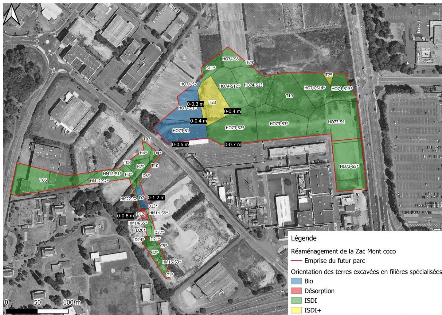
Figure 29 Orientation des terres excavées dans le cadre de la création du futur parc à différentes hauteurs entre 0 et 1 m.
