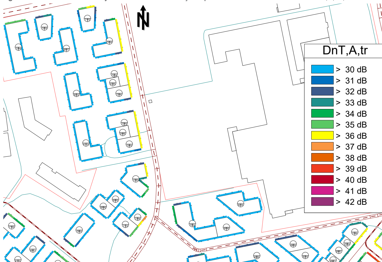
Figure 27: Identification des objectifs d'isolement de façade pour les bâtiments de la ZAC – Lots N, P, Q et W
