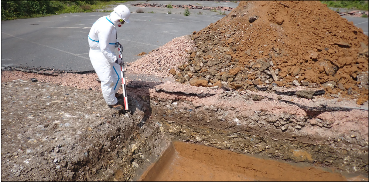
Fig. 18 Photo de la tranchée 4 où l'on observe en coupe les différentes couches de stabilisation (© A. Vantillard, CD14).
