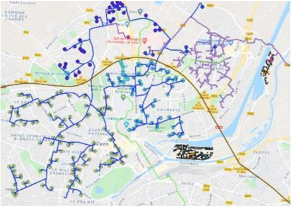
Schéma 25 : Tracé prévisionnel des extensions du réseau de chaleur urbain Caen Nord et des prospects à raccorder (Source : Schéma Directeur des Réseaux de Chaleur)
