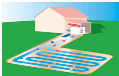
Schéma 16 : Principe de la géothermie horizontale
