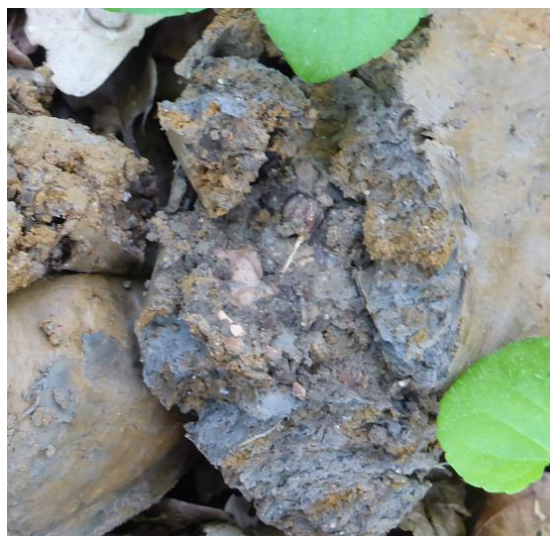
Traits réductiques (gley oxydé) observés en profondeur au sondage n°2
