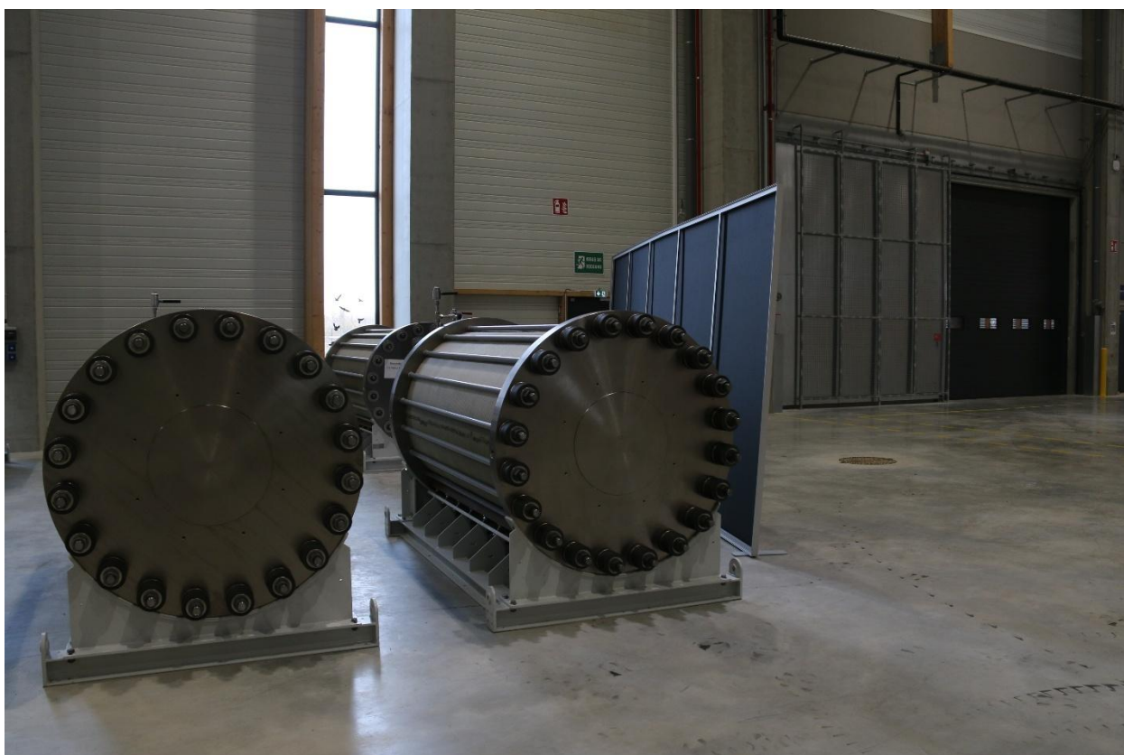
Vue d'un modèle stack constituant le cœur de l'électrolyseur.
