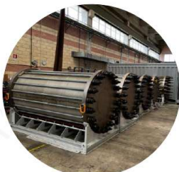
« XL Stack » Le cœur de l'électrolyseur
