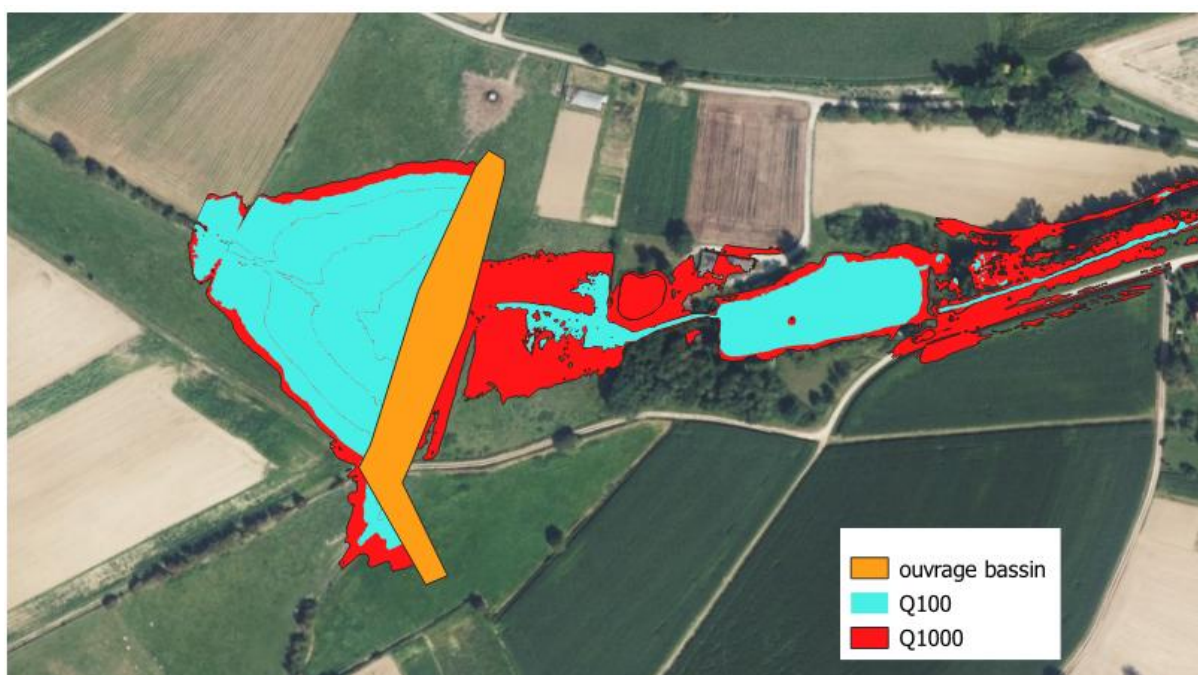
Figure 7 : Zone inondable, avec bassin de rétention pour une Q100 (crue de dimensionnement, et une Q1000 (l'ouvrage n'est plus efficace)
