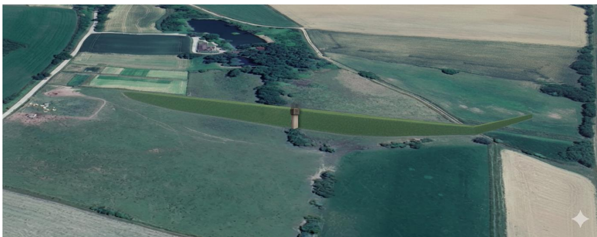
Figure 7 : Photomontage de l'ouvrage à sec (hors crue), vue du ciel, avec la tour de vidange au milieu
