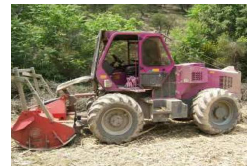
Figure 30 : Exemple de tracteur équipé d'un broyeur forestier Source : Société Forestière De La Durance, 2016
