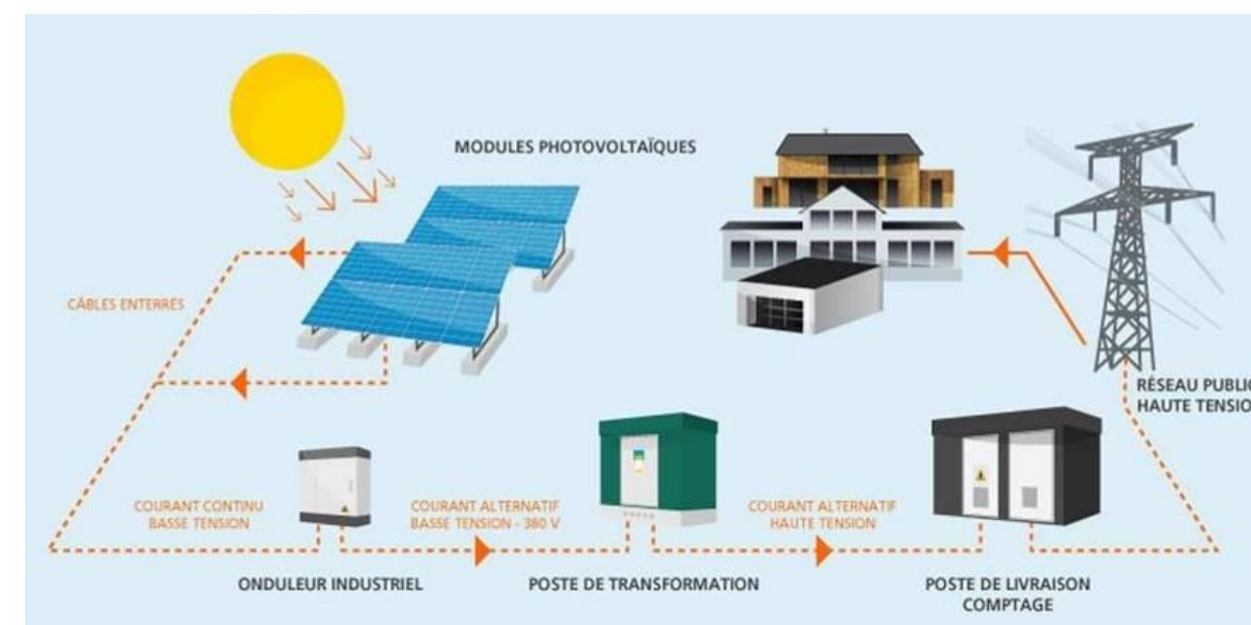
Figure 18 : Principe du raccordement électrique d'une installation photovoltaïque
