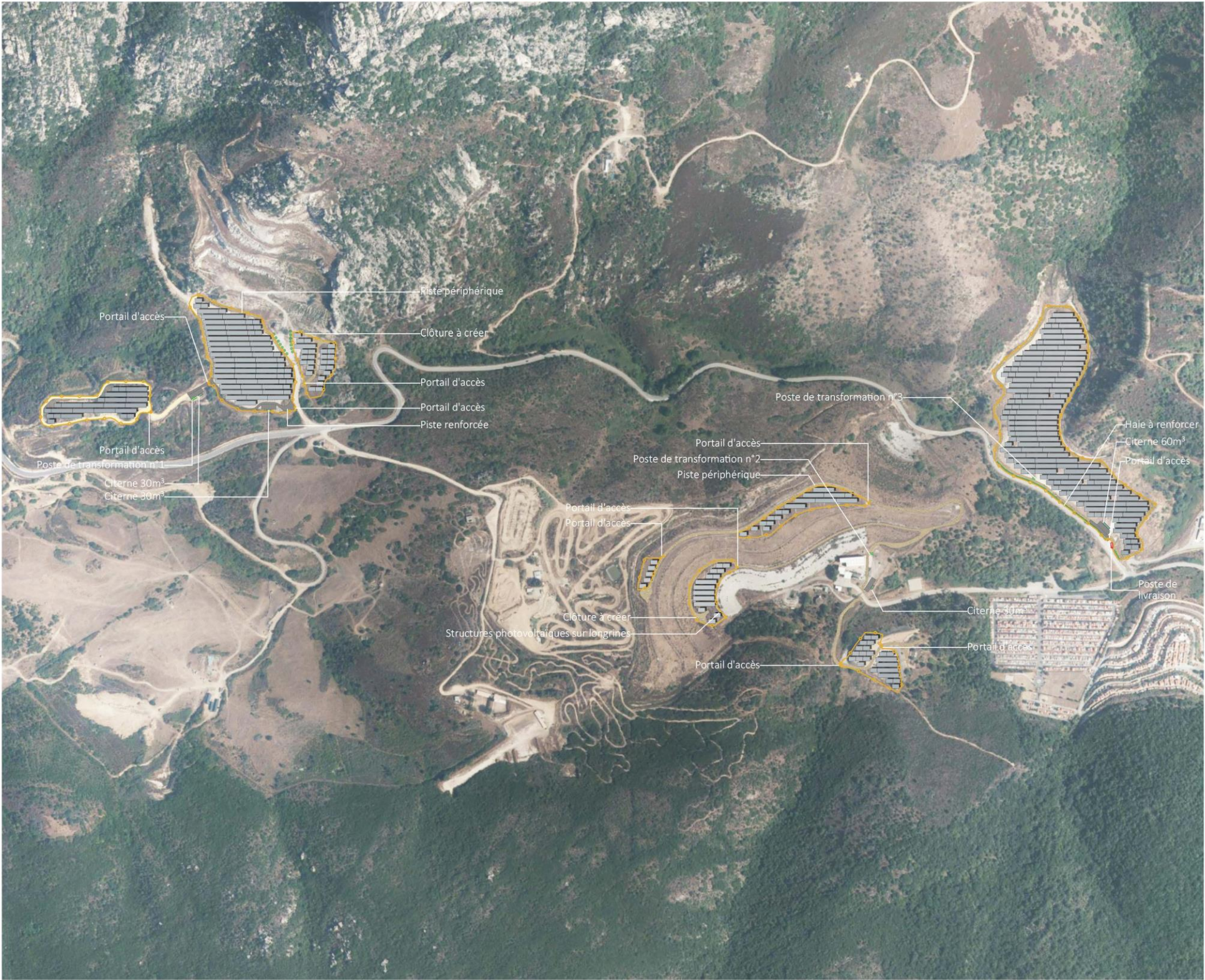
Figure 2. Plan de masse de la centrale photovoltaïque de Saint-Antoine (Source : Demande de Permis de Construire, I'M IN Architecture)
