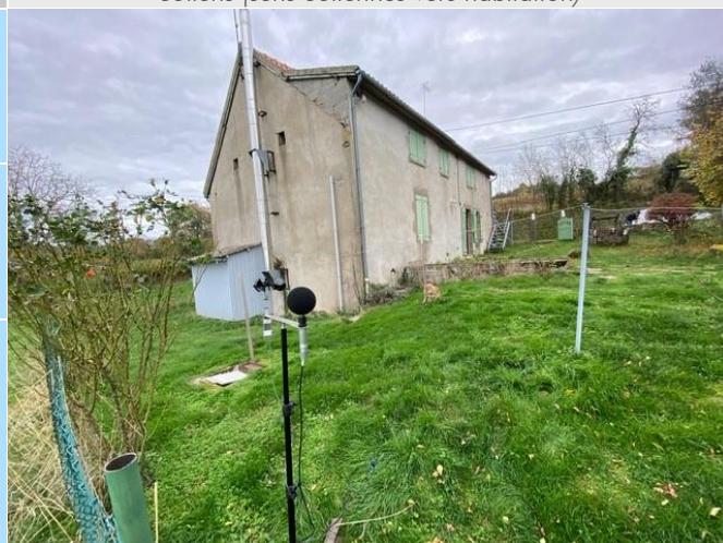
Le sens de la flèche matérialise le sens de propagation des bruits éoliens (sens éoliennes vers habitation)
