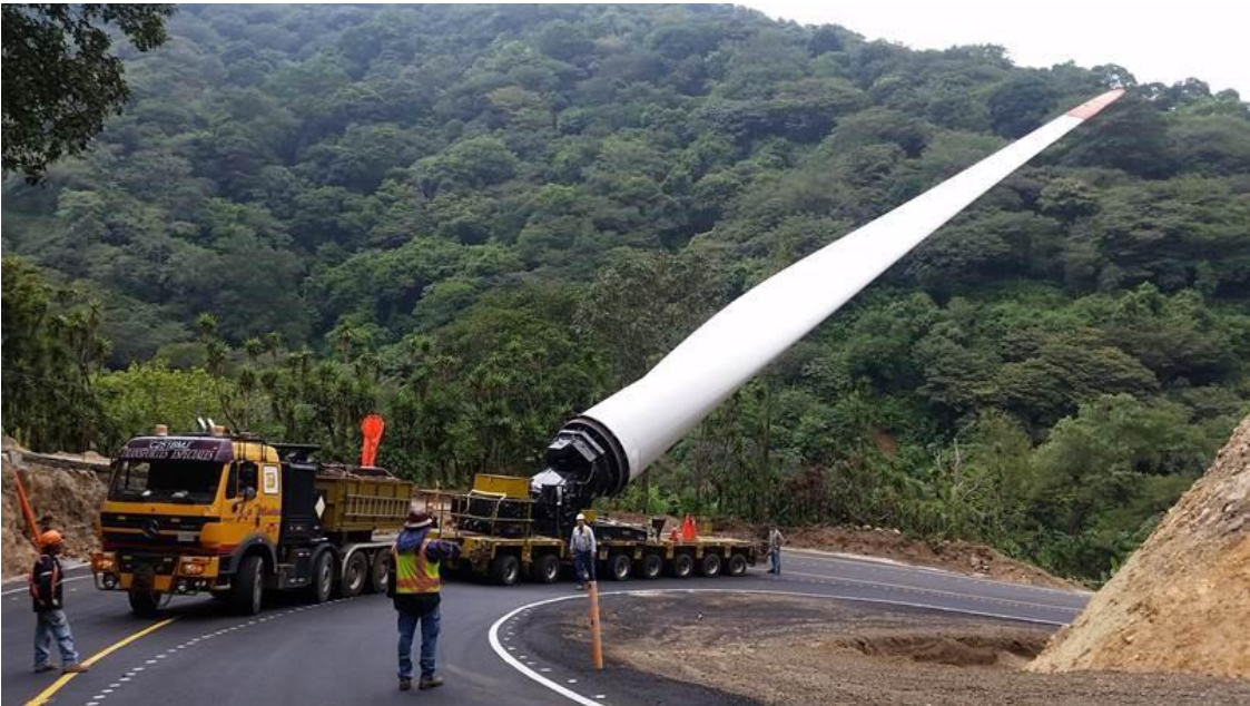
Figure 30 : Illustration d'un "blade lifter" négociant un virage serré
