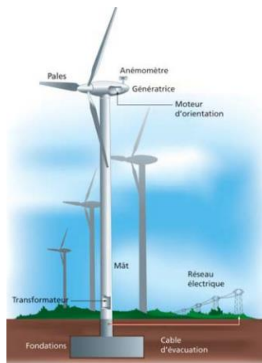
Figure 1 : Représentation schématique d'une éolienne (Source : EDF)
