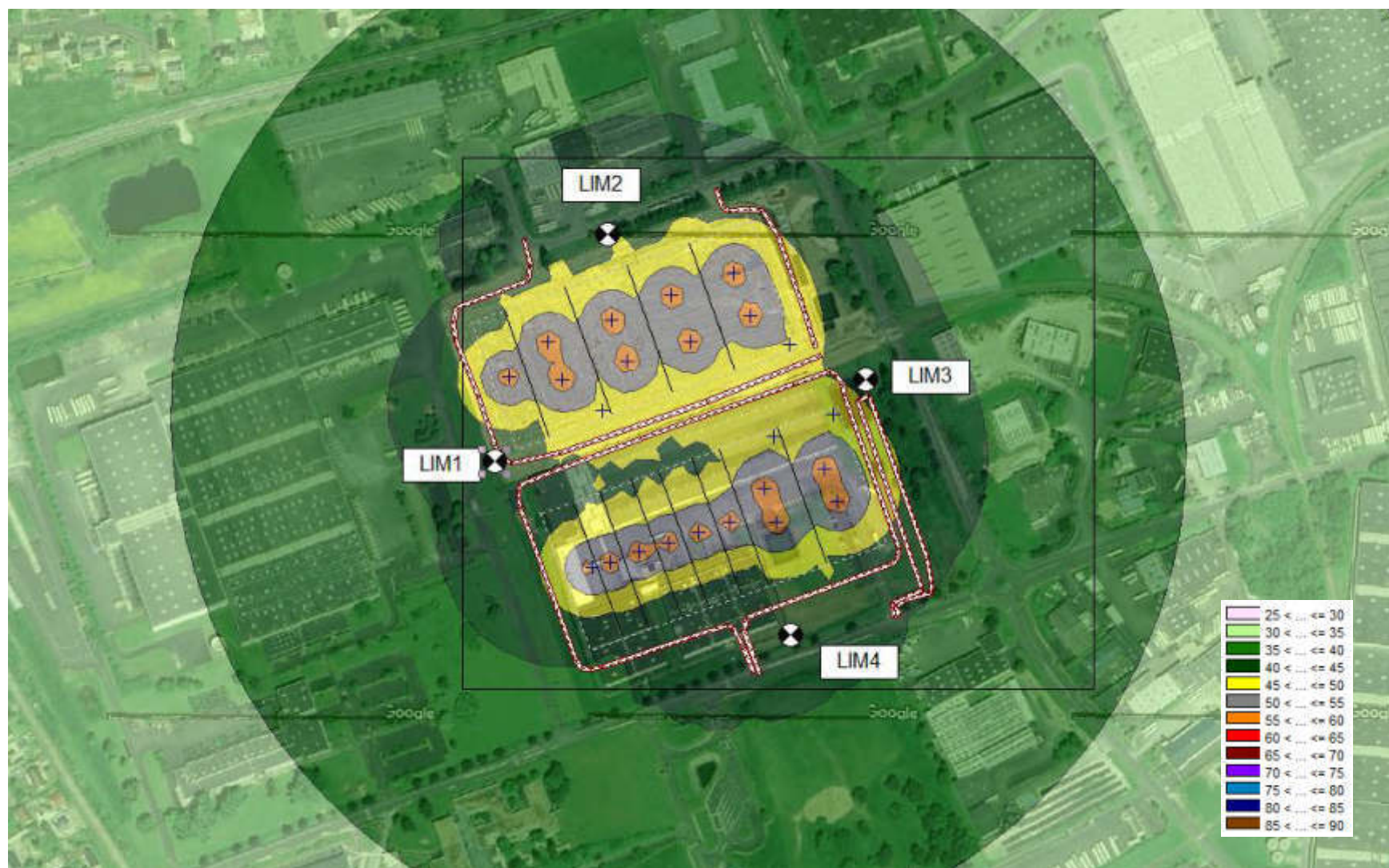
Figure 5 : Carte de bruit dans l'environnement généré par le fonctionnement des installations du projet de nuit (Calcul CadnaA – maillage 10 x 10 m)
