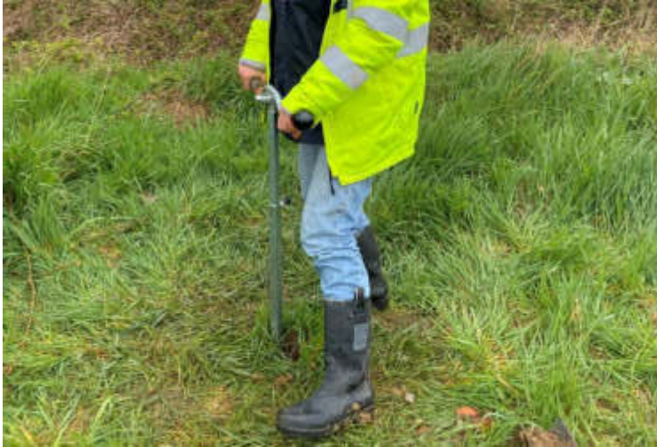
Figure 5 – Sondage à la tarière à main © ARP-Astrance 2022
