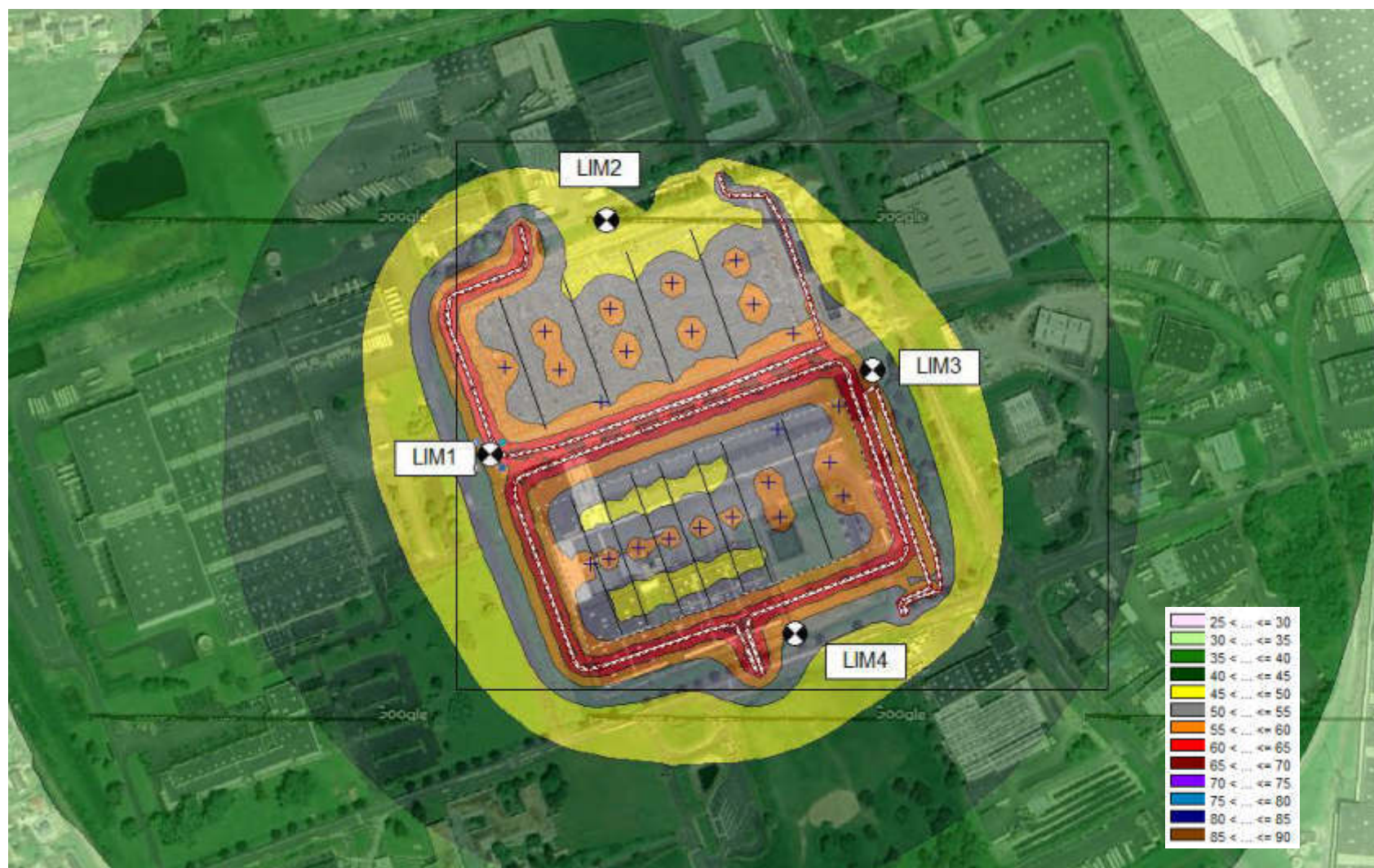
Figure 4 : Carte de bruit dans l'environnement généré par le fonctionnement des installations du projet de jour (Calcul CadnaA – maillage 10 x 10 m)
