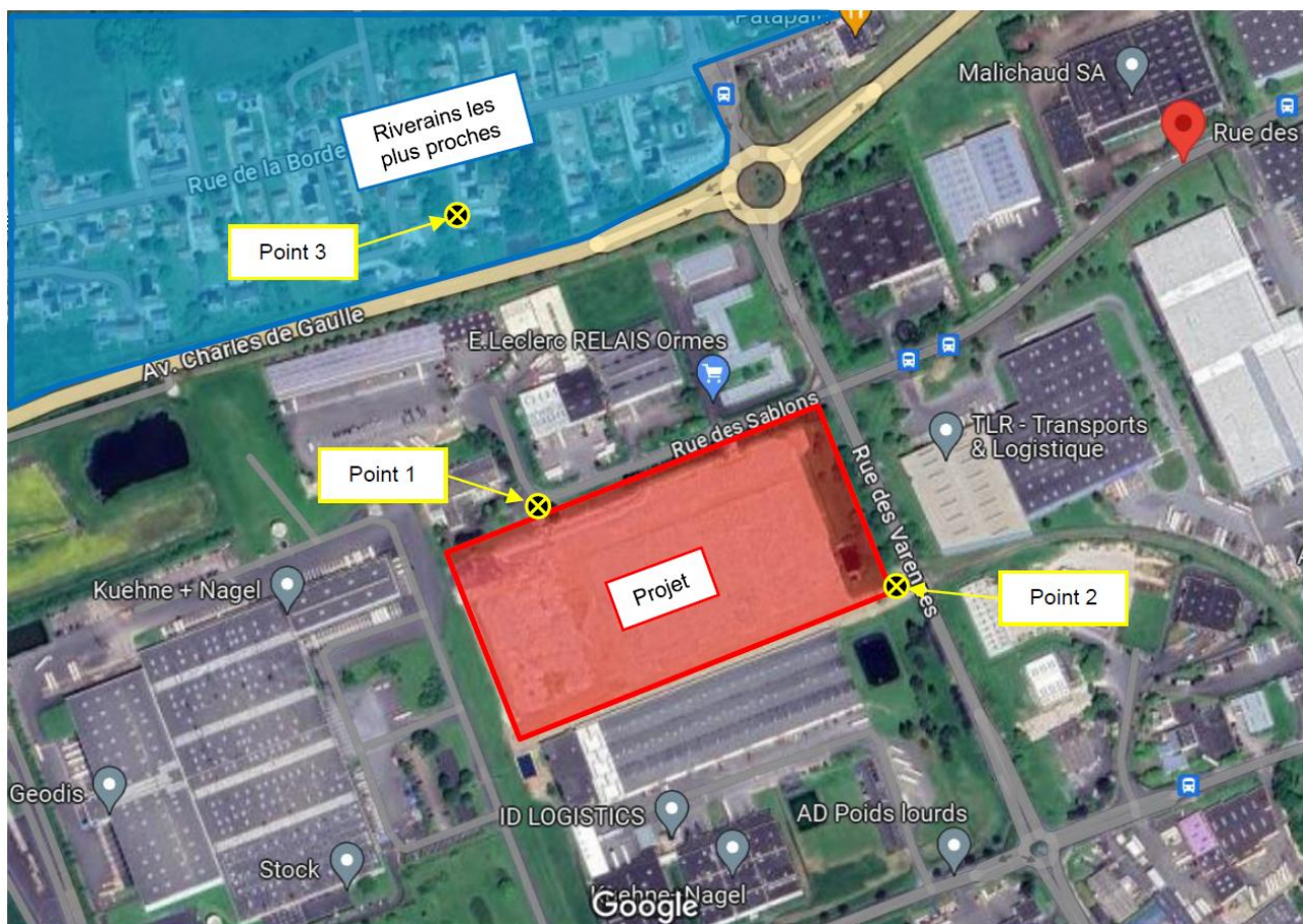
Figure 59 : Localisation des points de mesures de bruit (source : SOCOTEC)
