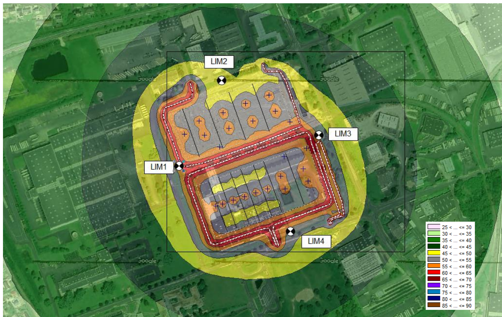
Figure 4 : Carte de bruit dans l'environnement générée par le fonctionnement des installations du projet de jour (Calcul CadnaA – maillage 10 x 10 m)
