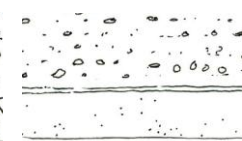
Soubassement enduit par un mortier épais à la chaux hydraulique naturelle (NHL 2 ou 3,5)
