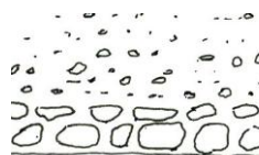
Soubassement en moellon jointoyé à la chaux hydraulique naturelle (NHL 2 ou 3,5)
