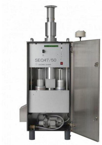
Figure 3. Préleveur séquentiel LECKEL SEQ47/50
