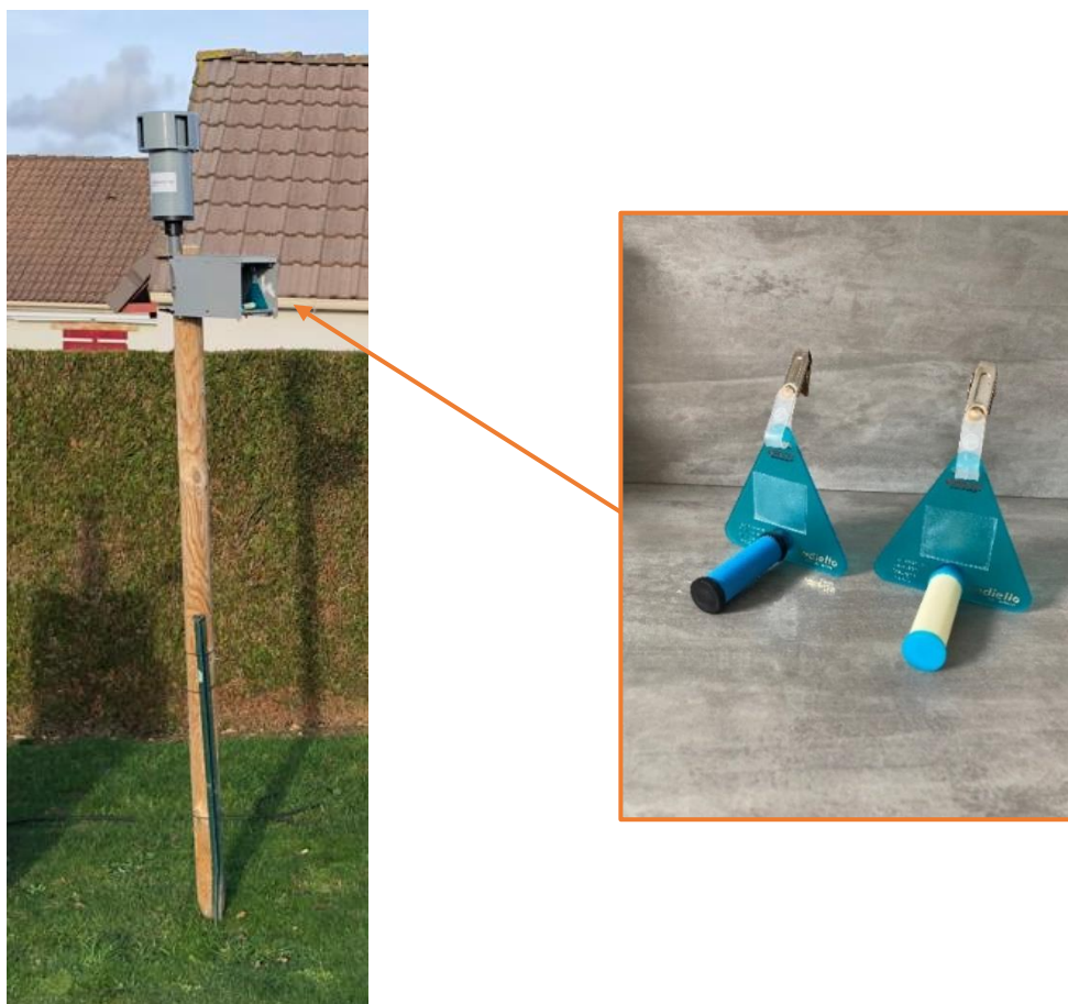
Figure 4. Tubes passifs Radiello© et support d'exposition
