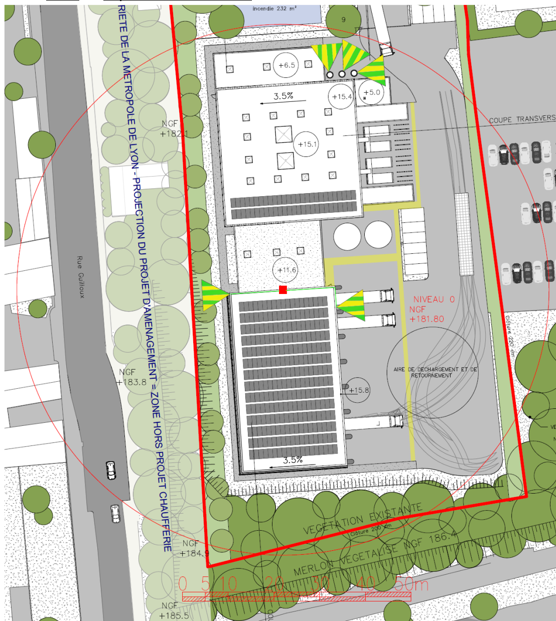
Figure 19 : Implantation des paratonnerres
