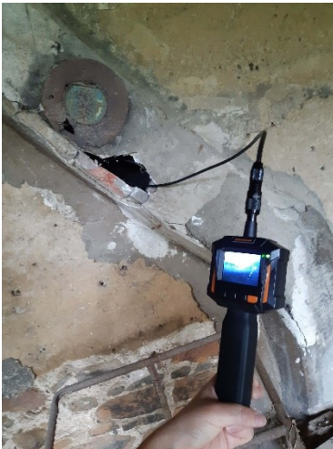
Figure 13 : Vérification d'une cavité à l'endoscope © EODD, 2023
