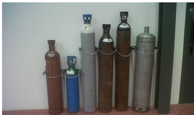
Stockage des bouteilles de gaz dans le hall
