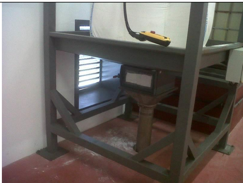
Alimentation en chaux de la vis sans fin
