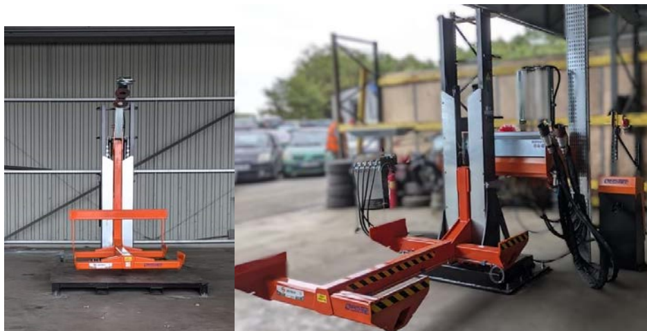
Figure 24 : Photographie de la station de dépollution IRIS-MEC-IBC et du retourneur de véhicule
