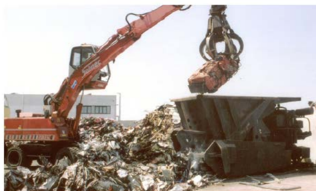
Cisaille un VHU avec moteur
