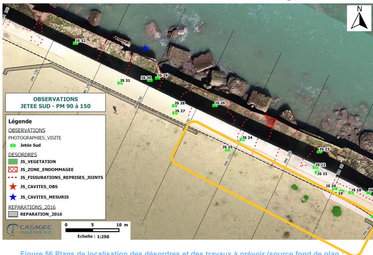
Figure 56 Plans de localisation des désordres et des travaux à prévoir (source fond de plan : ANTEA/CASAGEC 2020)
