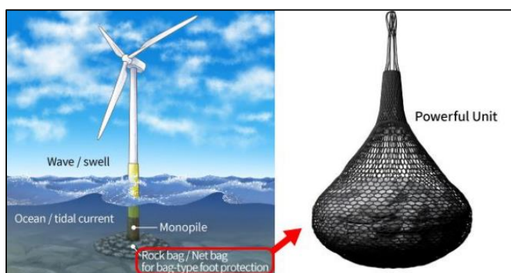
Figure 60 : Exemple d'utilisation de la solution Soiltain® Rock pour la protection des pieds d'éoliennes offshores ([source Huesker])
