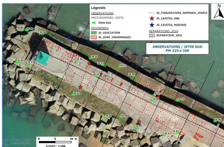
Figure 57 : Fissures repérées sur la dalle au niveau du musoir (Rapport 2021 ANTEA CASAGEC)
