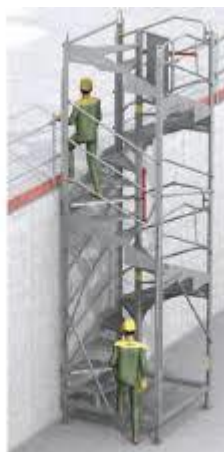
Figure 131: Exemple escalier de chantier colimaçon "Escalib"
