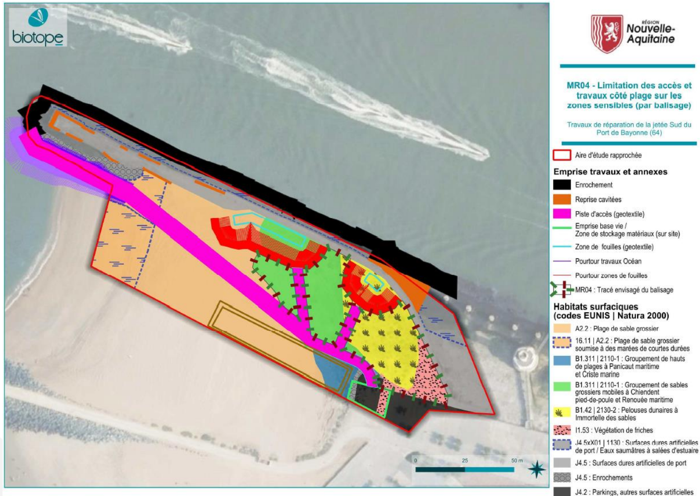
Figure 88 : Limitation des accès et travaux côté plage sur les zones sensibles par balisage (source : Biotope)
