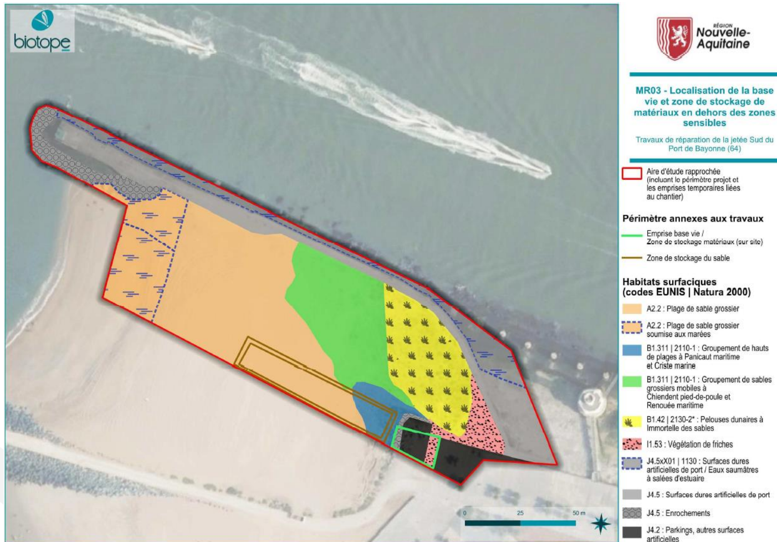
Figure 87 : Localisation des bases vie et zones de stockage de matériaux en dehors des zones sensibles (source Biotope)
