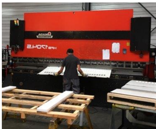
Photo 4 : Etape de pliage des tôles
