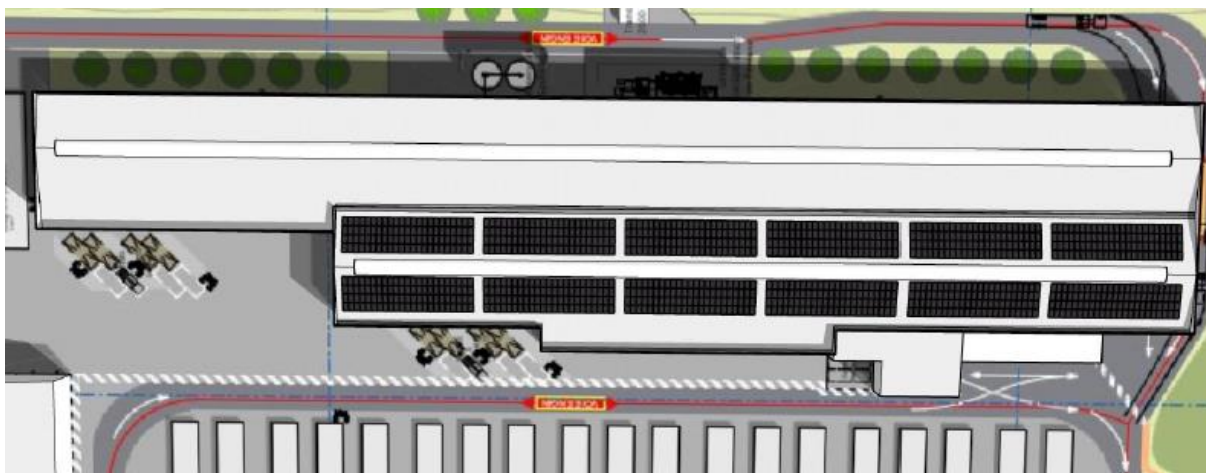
Figure 24 : Implantation des panneaux photovoltaïques phase I
