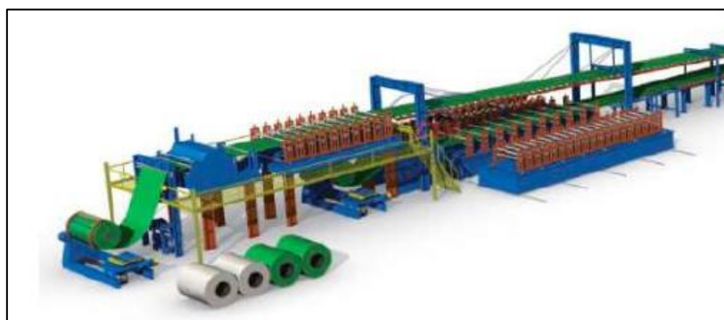
Figure 12 : Etape de déroulage et de profilage
