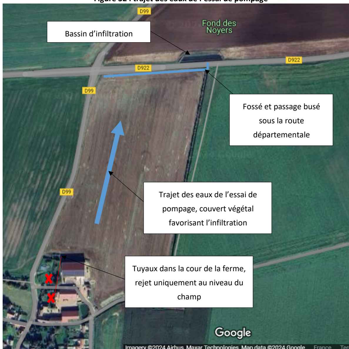
Figure 32 : trajet des eaux de l'essai de pompage
