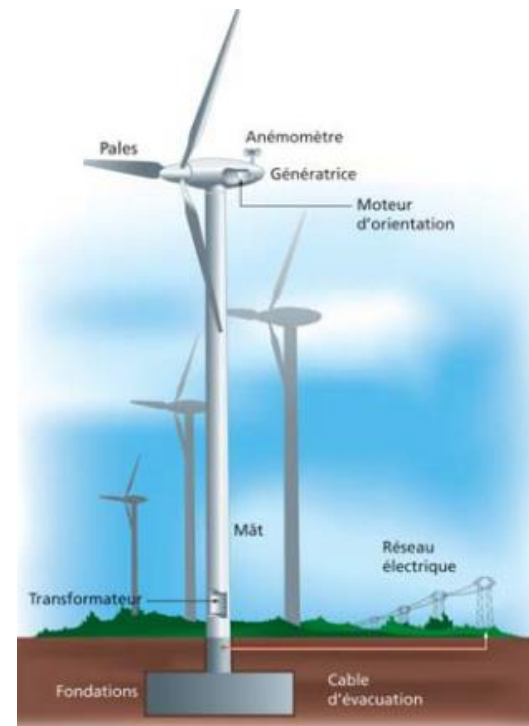
Figure 10 : Représentation schématique d'une éolienne (Source : EDF)
