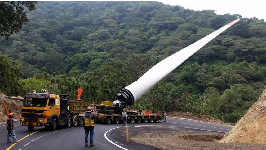
Figure 40 : Illustration d'un "blade lifter" négociant un virage serré
