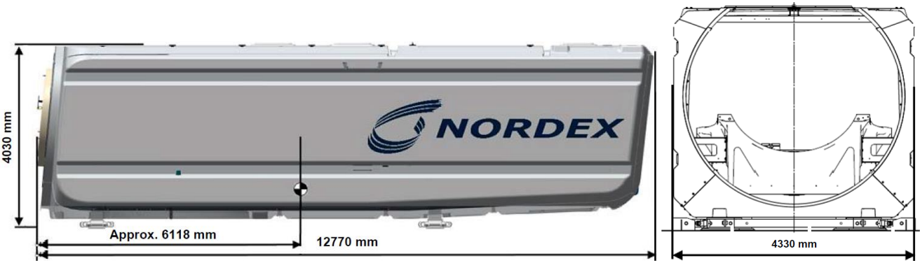
Figure 34 : Vue en coupe de l'espace nécessaire au transport de la nacelle (Source : NORDEX)
