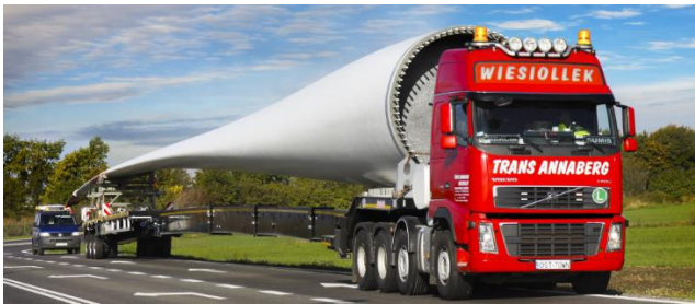
Figure 39 : Véhicule évolutif employé pour le transport de pale
