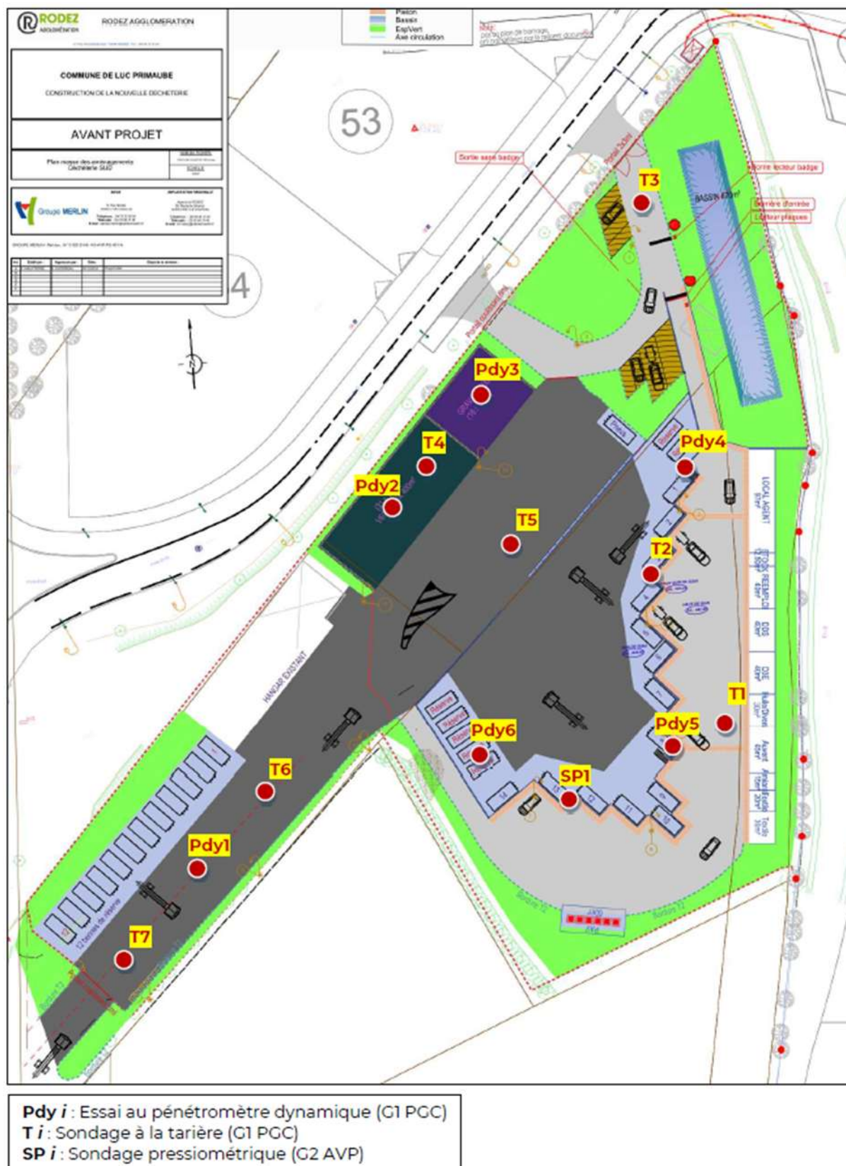
Figure 6 : Implantation des sondages géotechniques (source : rapport G2AVP -INGEOC 10/02/2025)
