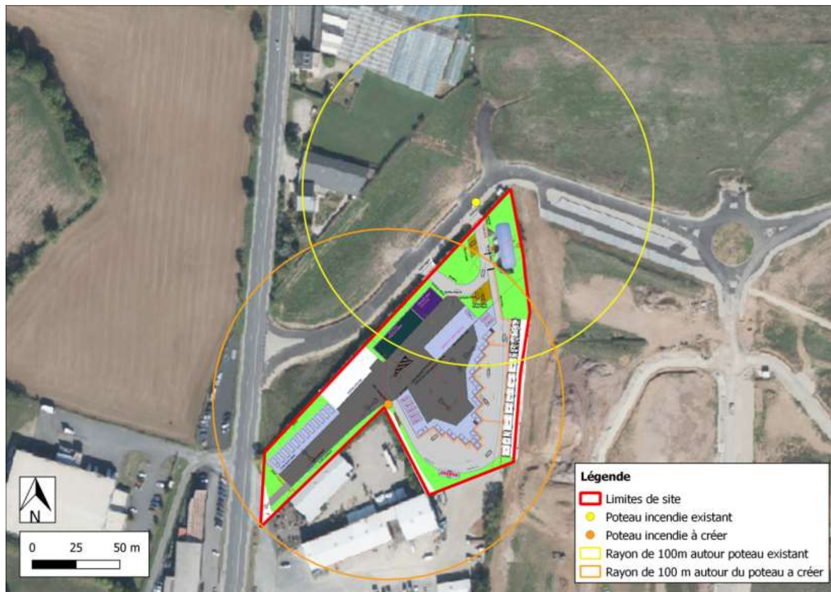
Figure 4 : Localisation des poteaux incendie
