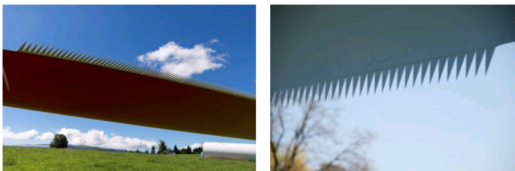
Photographies d'une pale dotée d'un système STE (peigne / dentelure)
