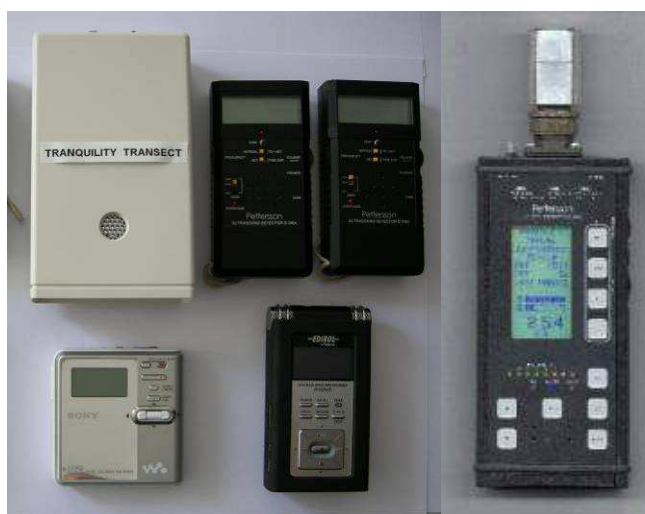
Photo 4 : Quelques détecteurs d'ultrasons et enregistreurs numériques utilisés lors de l'étude
