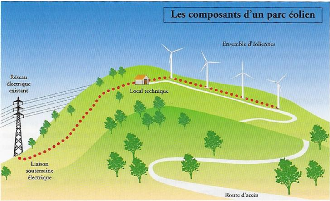
Figure 18 : Les composants d'un parc éolien
