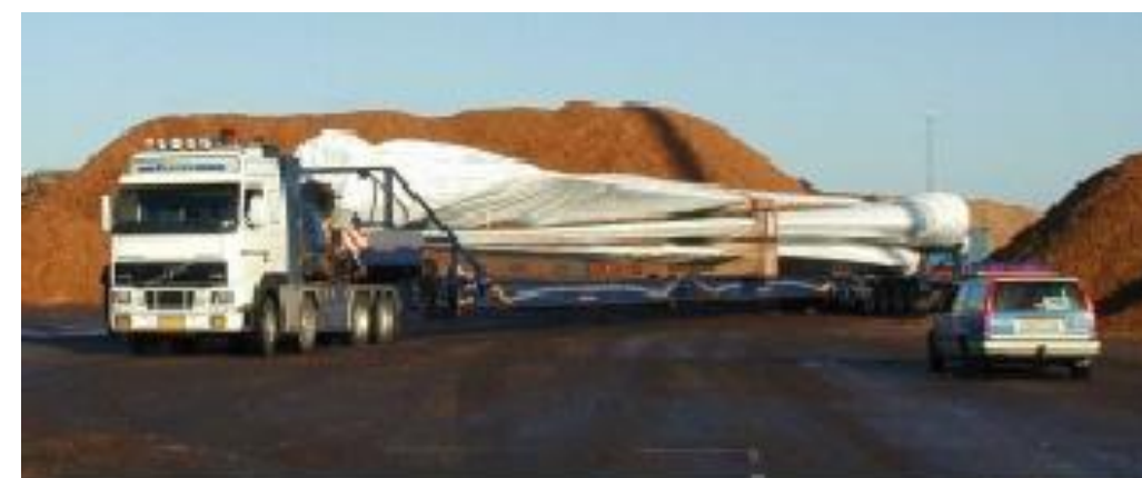
Photographie 2: Transport sur remorque des pales d'une éolienne
