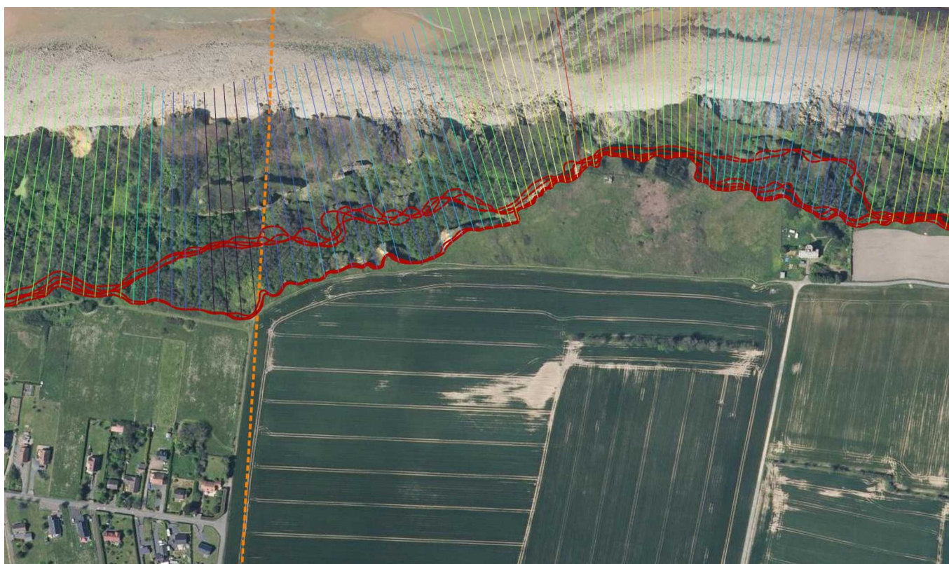
Figure 66: traits de côte issus de l'analyse des photographies aériennes exploitées (extrait centré sur le Bouffay et le sémaphore de Longues-sur-Mer). Les lignes rouges soulignent les emplacements respectifs du trait de côte pour chaque mission aérienne analysée.
