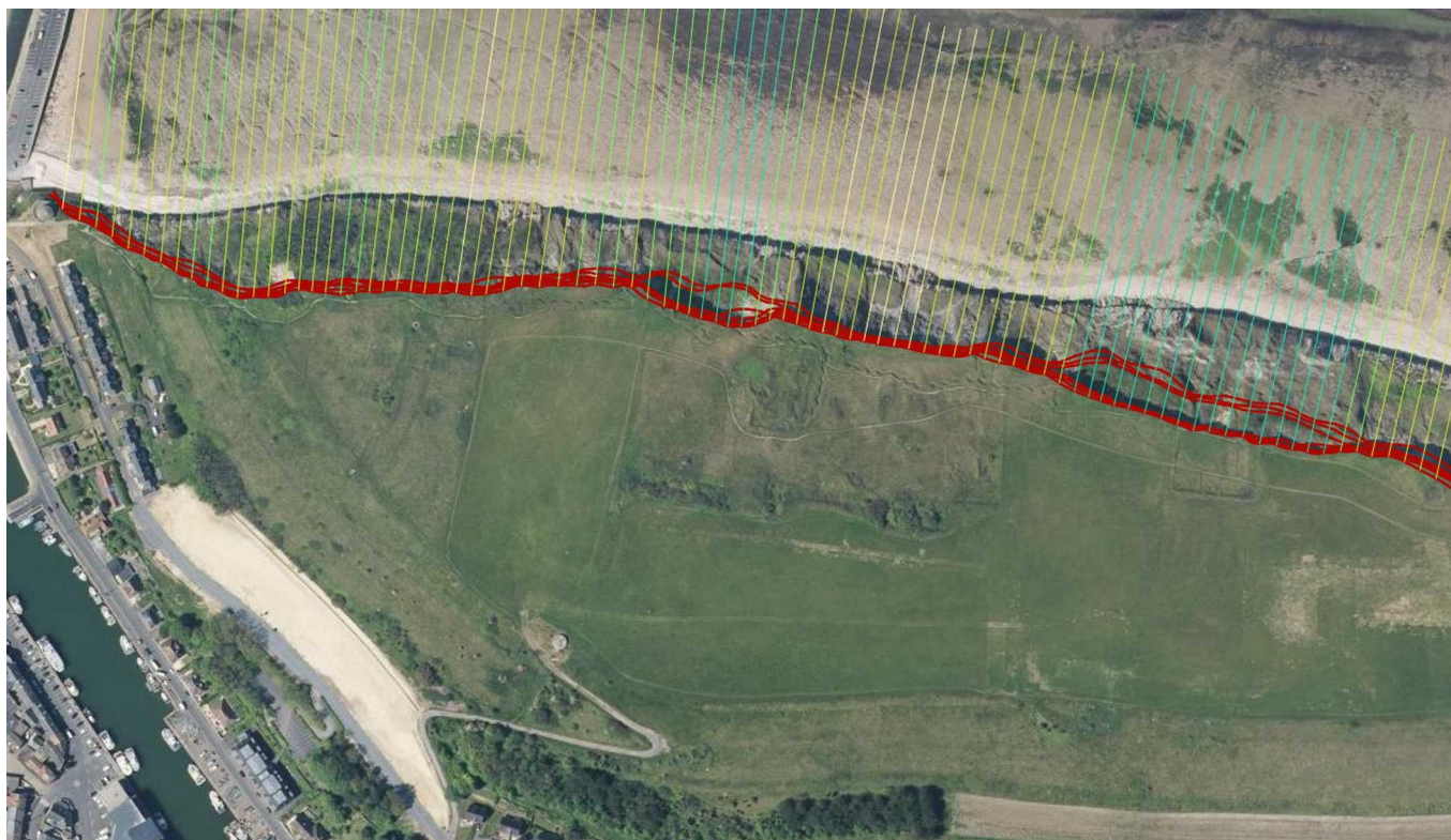
Figure 65: traits de côte issus de l'analyse des photographies aériennes exploitées (extrait centré sur le Mont-Castel). Les lignes rouges soulignent les emplacements respectifs du trait de côte pour chaque mission aérienne analysée.
