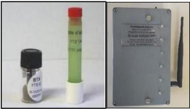
Figure 35 : Tubes passifs et micro-capteur laser
