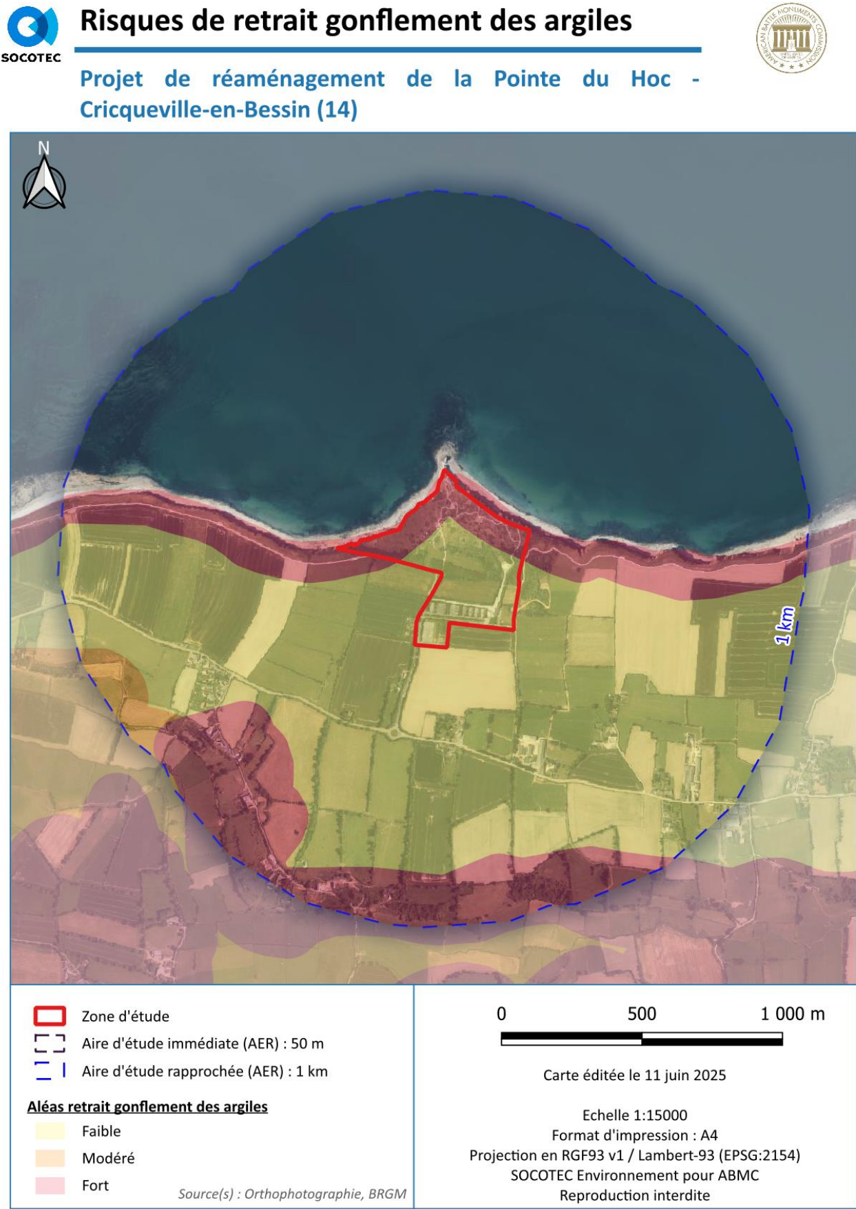
Figure 29 : Risque de retrait gonflement des argiles au niveau de la Pointe du Hoc
