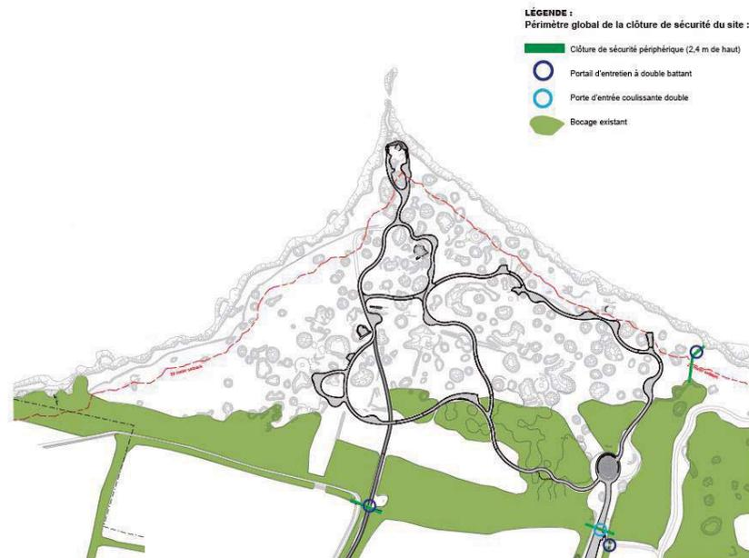
Figure 37 : Diagramme de clôture de sécurité périmétrique – Source : Permis de construire
