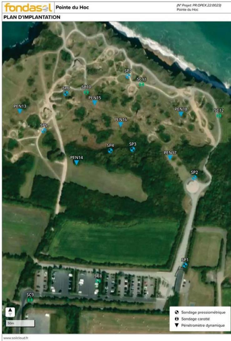
Figure 46 : Localisation des points de sondages réalisés par Fondasol
