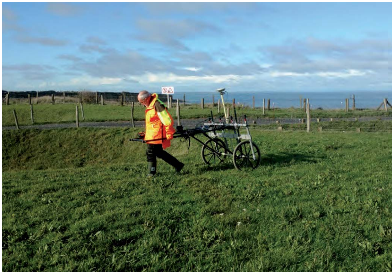
Figure 3 : Magnéto-mètre multisonde Vallon monté sur un chariot à magnétique.
