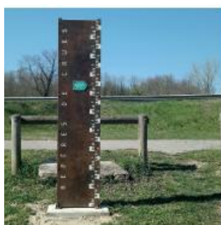
Repere des niveaux d'eau
