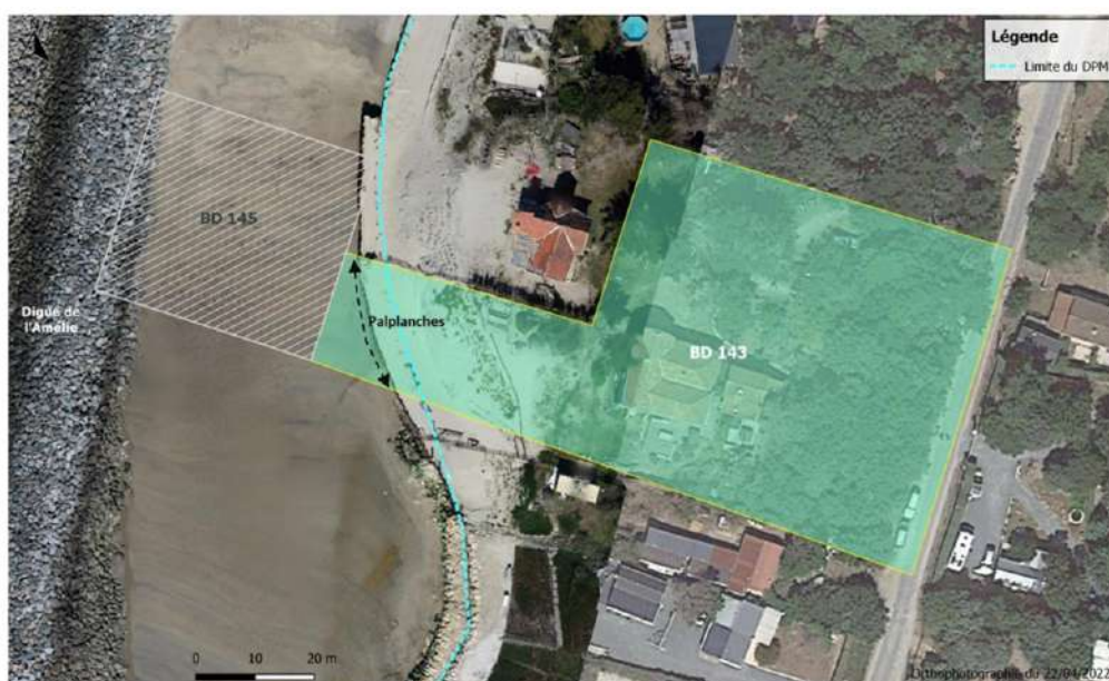
FIGURE 6. EXEMPLE DE PARCELLE PRIVEE PROTEGEE PAR DES PALPLANCHES (PROTECTION INDIVIDUELLE, CASAGEC INGENIERIE, DECEMBRE 2022)
