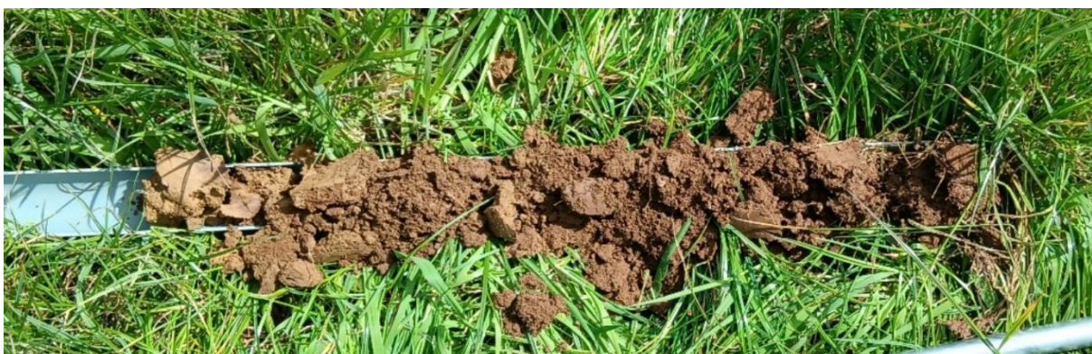
photographie 3 : Exemple de carottage sur une profondeur de 70 cm (photo AEPE Gingko)
