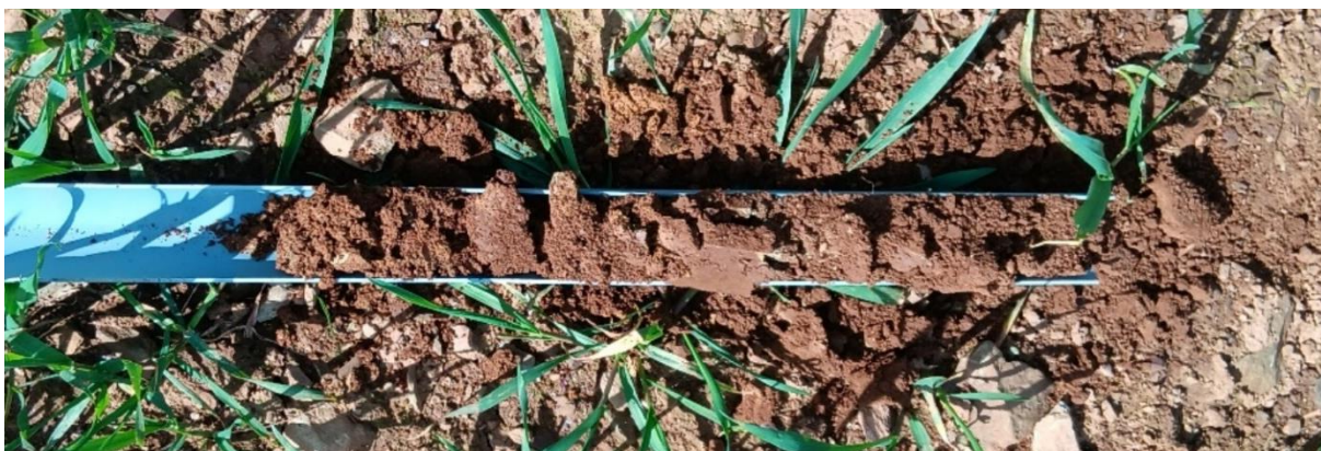
photographie 2 : Exemple de carottage sur une profondeur de 70 cm (photo AEPE Gingko)
