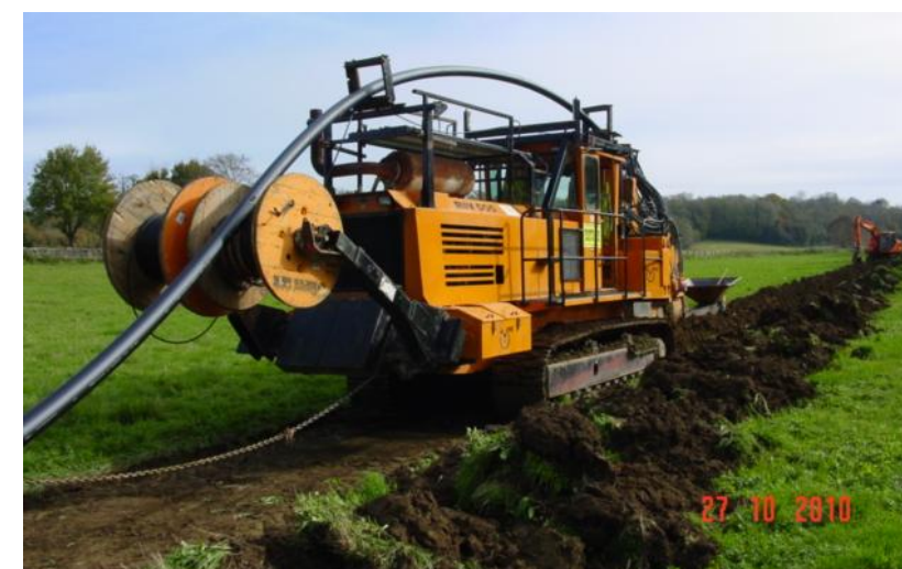
Type de trancheuse utilisée dans le cadre d'enfouissement de câbles (Source : tattu.fr)
