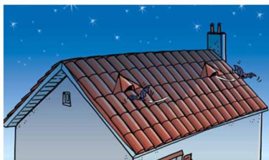
▲ Chiroptère tuile spéciale permettant l'accès des combles de la maison par les chauves-souris
