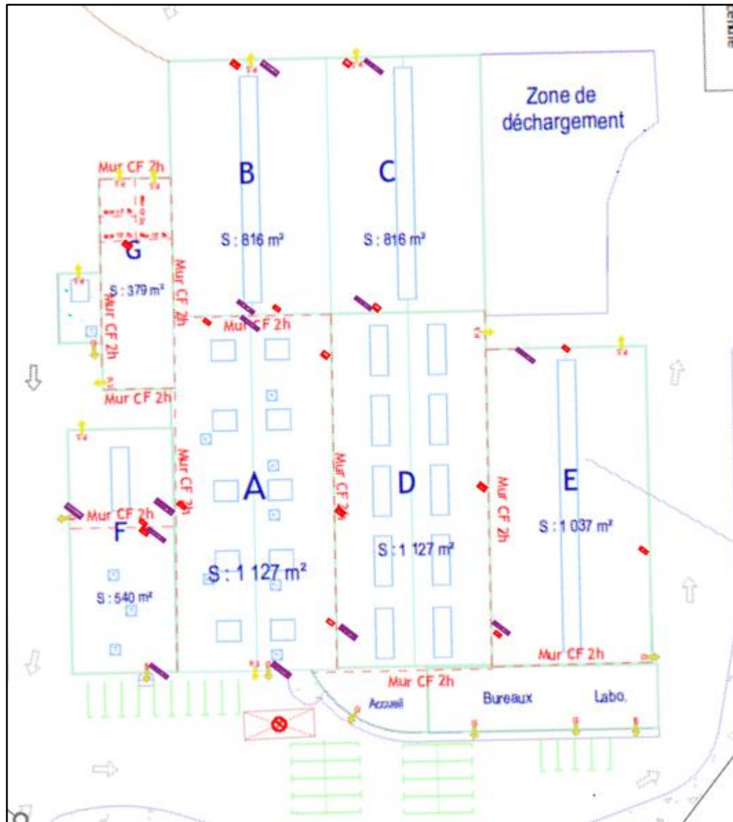
Figure 6 : Localisation des murs coupe-feu bâtiment existant (source : sicabconstruction)
